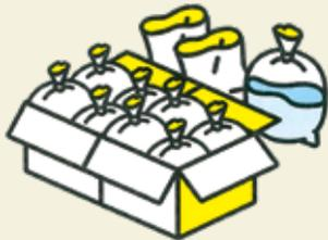
二重にしたごみ袋に半分程度水を入れたものをダンボール箱に入れ連結して簡易水のうとして使用します。
