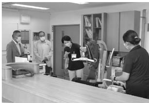
介護支援ロボット：立ち上がりをサポートし、介護者の負担を軽減する
