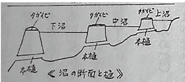
ため池の構造を描いた「沼の断面と樋」…滑川村史（民族編）より
