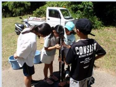
透視度計で透明度を計測する様子
